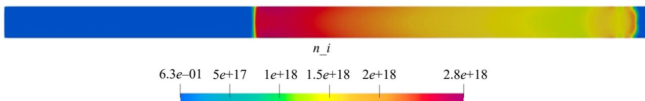
Fig. 9. Nanoparticle distribution, m<sup>-3</sup>
